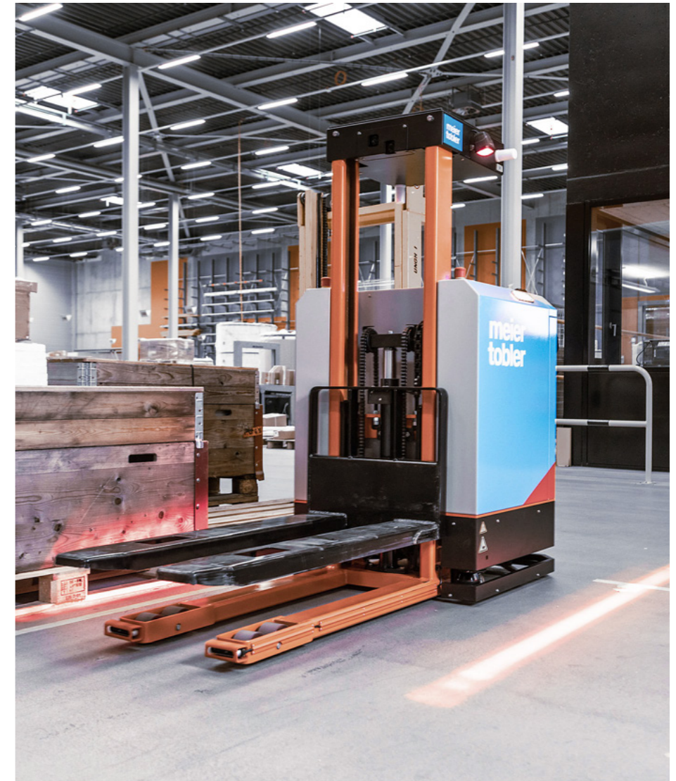
Im Dienstleistungszentrum Oberbuchsitzen stehen 11 Autonome Mobile Roboter (AMR) im Einsatz.
